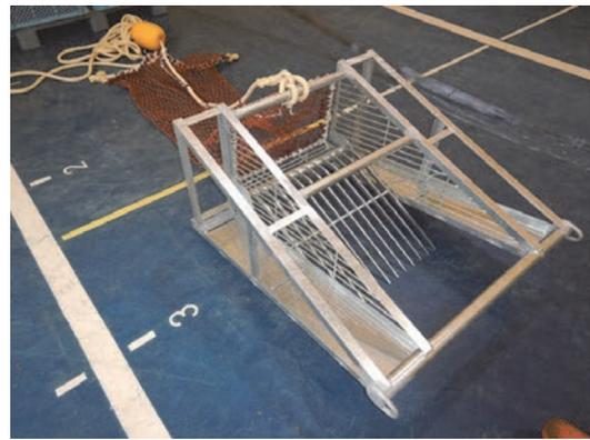
図2 使用した桁網
