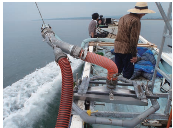
図5 採集試験に用いたアサリ稚貝吸引装置
