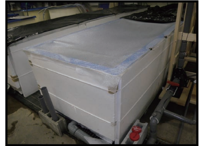
水槽側面は発泡スチロール、 上部はエアークャップで覆う
