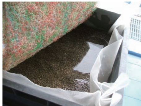
注水による砂洗堀防止のためのサランロックと砂
